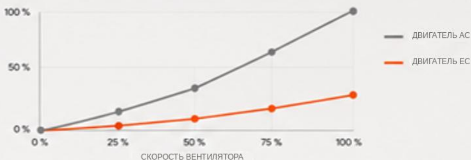
РАСХОД ЭНЕРГИИ (НА РАБОТУ ВЕНТИЛЯТОРА)
